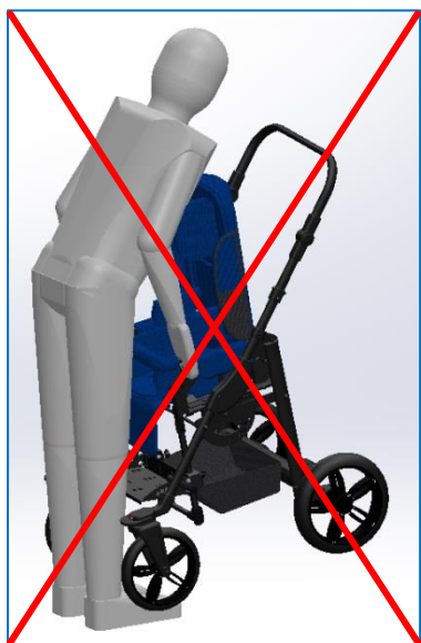
Rys. 5 Nieprawidłowy sposób przenoszenia wózka
