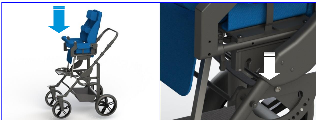
Rys. 2 Mocowanie siedziska do ramy wózka
