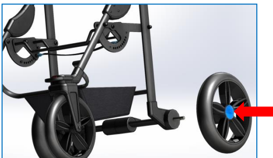
Rys. 12 Wypinanie i montaż kół tylnych
