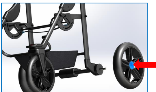
Rys. 12 Wypinanie i montaż kół tylnych
