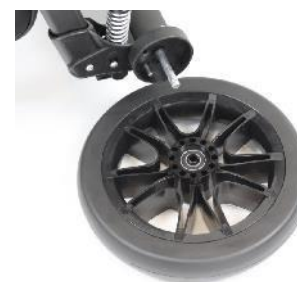
Zdj. 9.5.2 Demontaż koła
