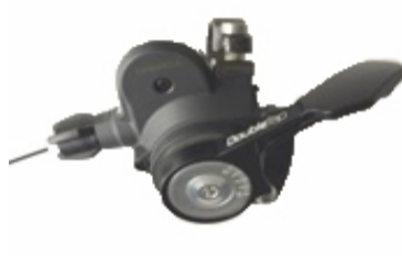
Przerzutka typu uniwersal, cynglowa
