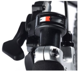
Przerzutka, manetka typu trigger shifter
