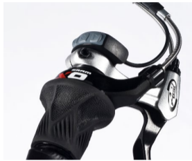
Przerzutka, manetka obrotowa, 10-biegowa
