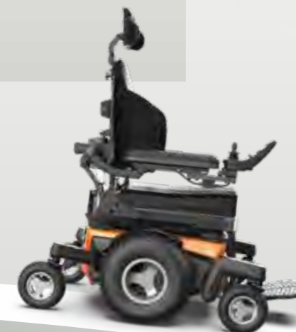
Koła napędowe 14" Off-road 14" zapewniają wyjątkową przyczepność w terenie (rozstaw 660 mm / 26")
